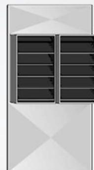
Pannellon con griglie afoniche superiori
