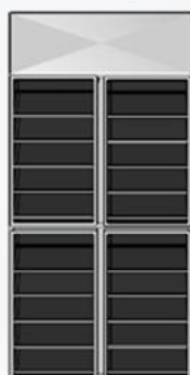
Pannello con quattro griglie afoniche
